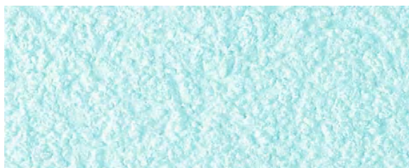
zrnitá struktura, velikost zrna 1,5 mm, odstín MA2E
